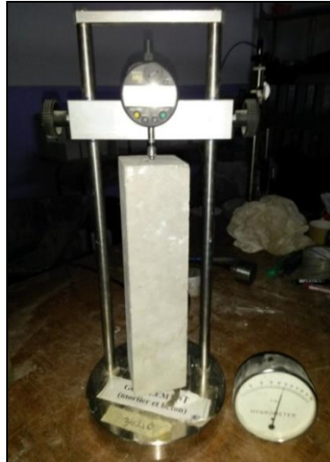
Photos I.6 Essais de mesure du retrait
