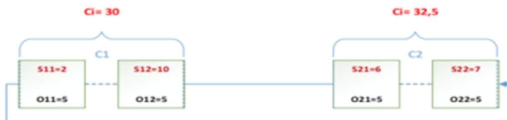
L'équation (3) alloue une plus grande fiabilité au composant 2 (C2) qu'au composant 1 (C1), bien que le composant 1 ait un mode de défaillance avec une sévérité **10**.
