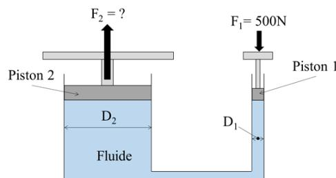
Une presse hydraulique est composée de deux pistons de diamètre très différents comme indiqué sur la figure. Les diamètres de petit piston et de grand piston sont respectivement 4cm et 32cm.
