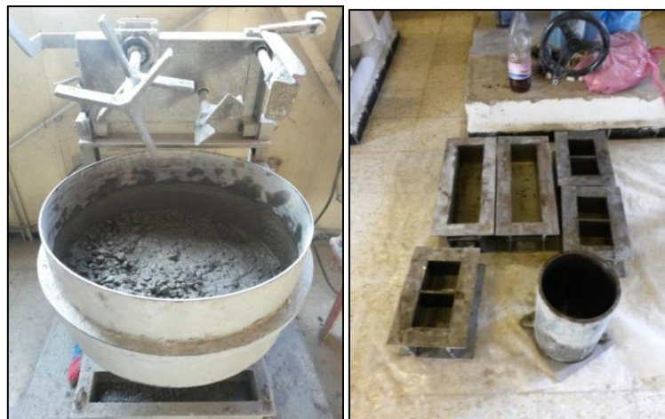
Figure I.34. Malaxeur et moules utilisés pendant les essais
