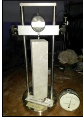
Figure I.27 Appareil de mesure du retrait
