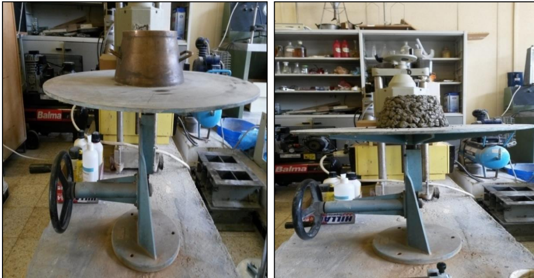
Figure I.24 : Essai réel de table à secousses [1]
