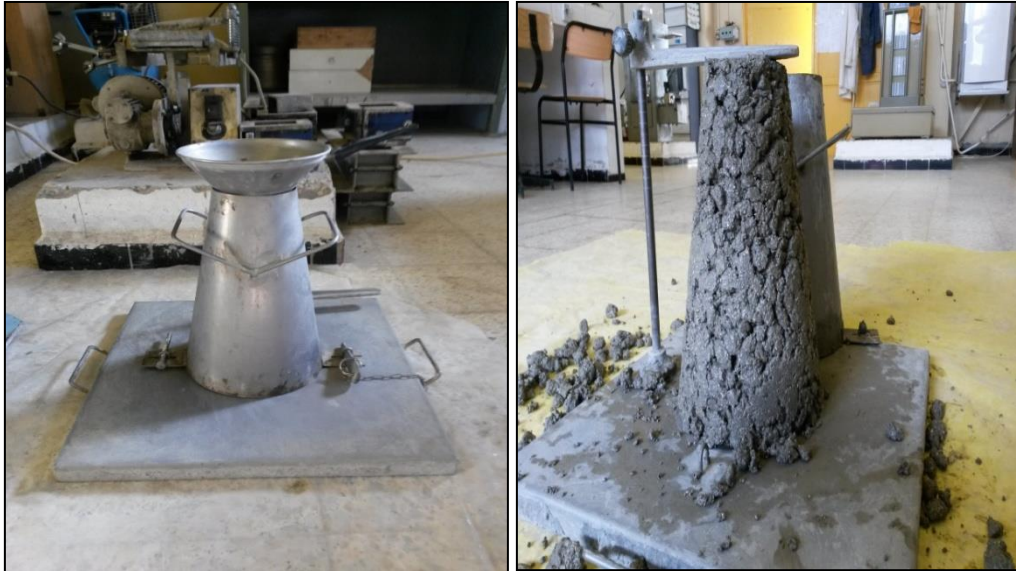
Figure I.22. Essai réel d'affaissement au cône d'Abrams [1]
