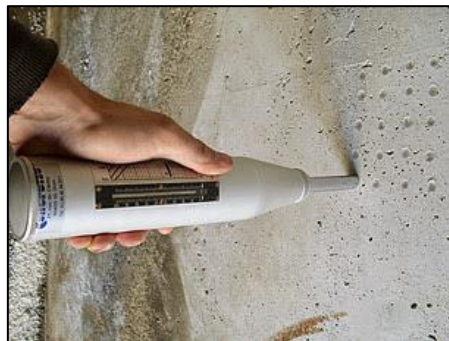
Figure I.32. Principe de l'essai sclérométrique
