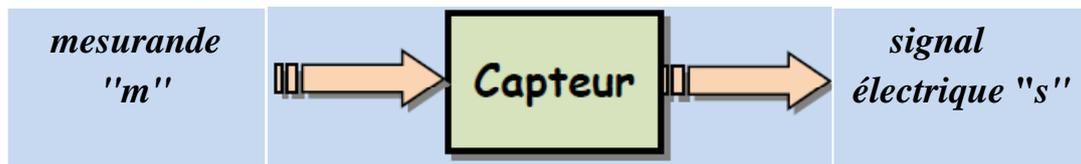
"s" est la grandeur de sortie ou réponse du capteur, m est la grandeur d'entrée ou excitation . La mesure de "s" doit permettre la connaissance aussi exacte que possible du mesurande "m".
