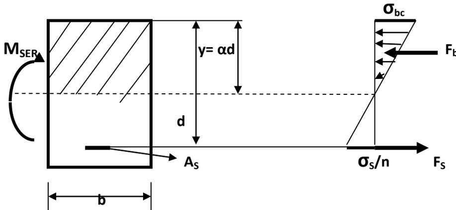
Si la condition  $\sigma_s \leq \bar{\sigma}_s$  n'est pas vérifiée, il faut recalculer  $A_s$  en supposant que  $\sigma_s = \bar{\sigma}_s$
