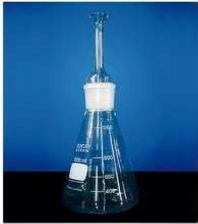
Figure V.1. Pycnomètre.
