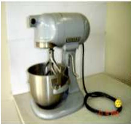
**Figure V.5.** Malaxeur pour mortier.
