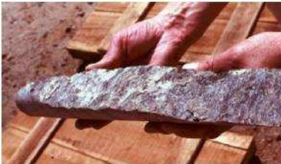
La rugosité de la surface du joint
