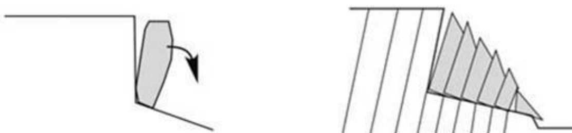
Rupture par fauchage ou basculement de colonnes ou de blocs
