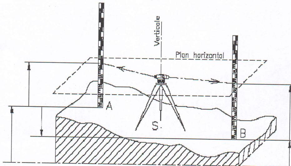
Principe de base du nivellement direct
