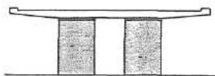
Appui composé de voiles
