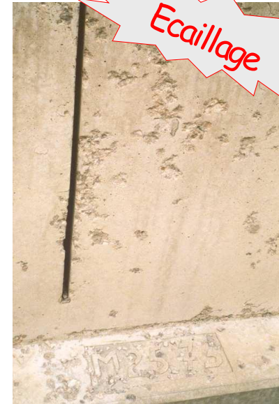
Corps d'épreuve exposé au gel et aux sels
