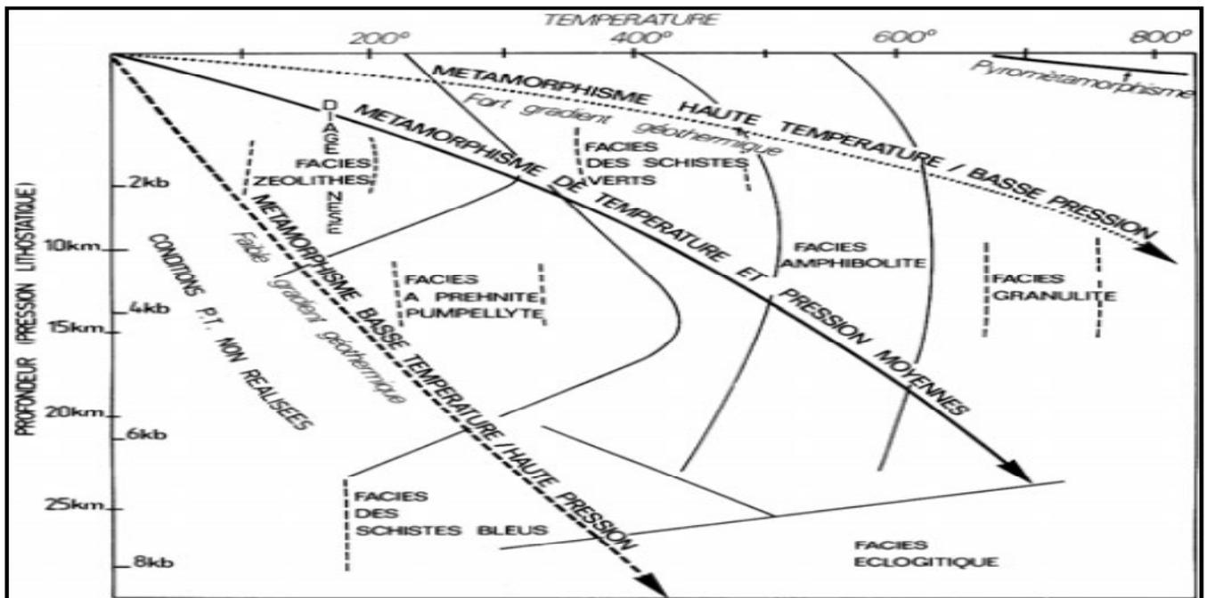
Fig. 125 59. Le métamorphisme des matériaux de la lithosphère est fonction, essentiellement, de la pression P et de la température T.
