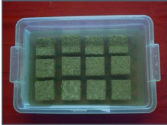
Figure II -12 : Eprouvettes cubiques 50x50x50mm immergées dans la solution acide.
