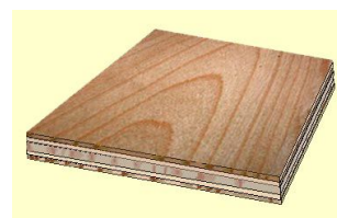
Forme finale du contreplaqué Les cinq feuilles sont ensuite encollées et pressées pour donner une planche d'épaisseur régulière
