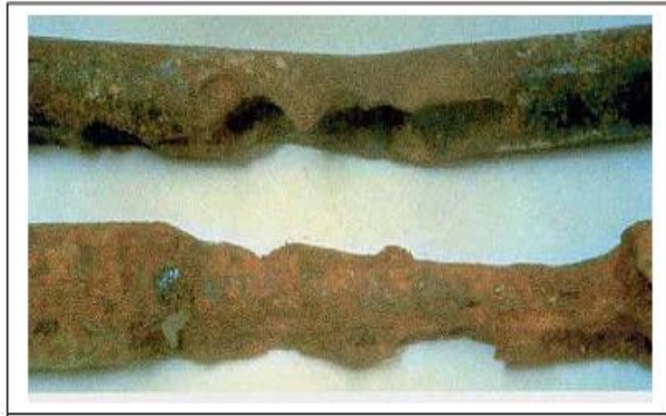
Figure I.7 : Piqure profonde causée par une attaque de chlorure. [46].
