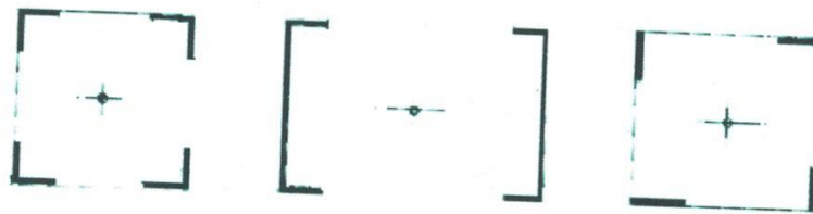
Fig. b. - Disposition incorrecte des éléments rigides par rapport au centre de gravité des niveaux. Les murs formant les panneaux de contreventement du rez-de-chaussée étant décentrés, ces constructions peuvent être soumises par les séismes à une torsion importante.
