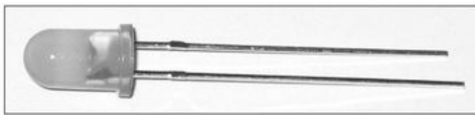
Figure 6-9 : Sur une LED unicolore classique, la branche la plus courte est le prolongement de la cathode.
