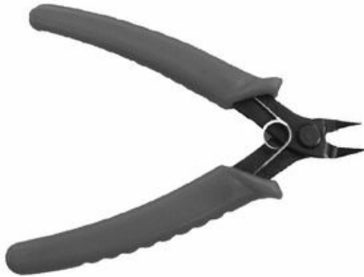
Figure 9-3 : Une pince coupante pour couper les fils électriques.
