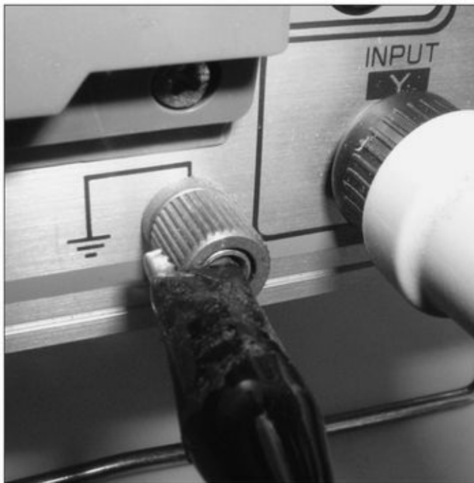
Figure 13-6 : Branchez le cordon de masse sur la prise masse de l'oscilloscope.
