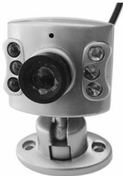
Figure 15-7 : Cette caméra miniature peut voir dans l'obscurité, grâce à ses six diodes émettrices de rayons infrarouges (IR LED).
