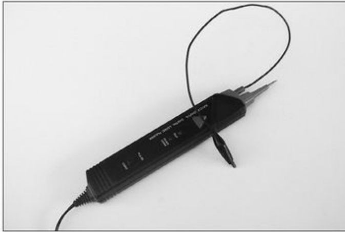
Figure 16-3 : Le générateur d'impulsions logiques envoie une brève impulsion ou une série d'impulsions dans le circuit.
