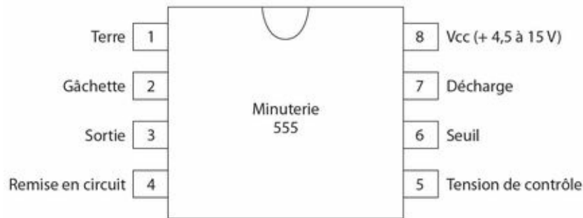
Figure 7-8 : Brochage d'une minuterie 555.
