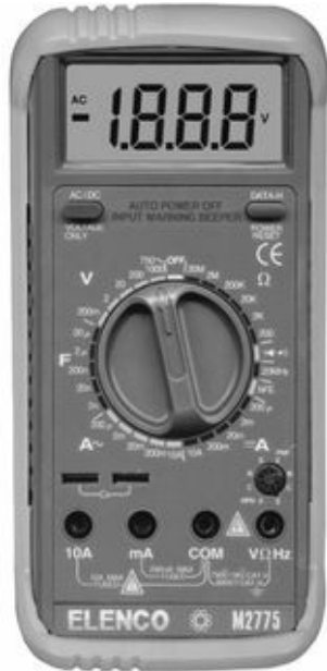
Figure 9-2 : Un multimètre permet de mesurer la tension, la résistance et l'intensité.
