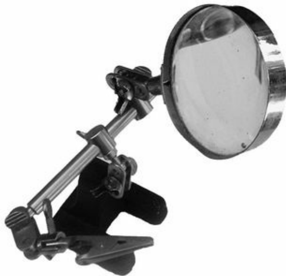
Figure 9-4 : Une troisième main garnie de pinces et d'une loupe.
