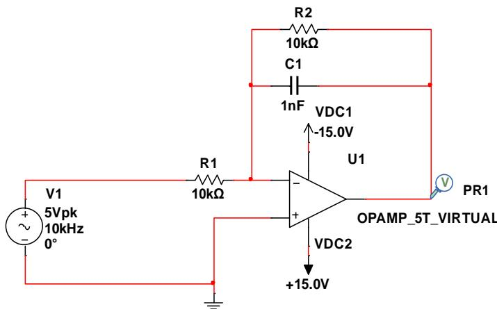
1. Visualisez le gain et la phase en fonction de la fréquence en mode AC Sweep avec l'axe vertical en décibel puis remplissez le tableau suivant :
