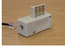
Figure 3.3 Connecteur RJ11 et son adaptateur ancienne norme française
