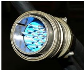
Connecteur MIL-DTL-38999 à 16 pins
