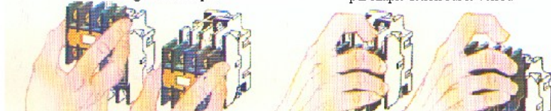
Montage de contacts auxiliaires sur contacteur série D (Télé mécanique)
