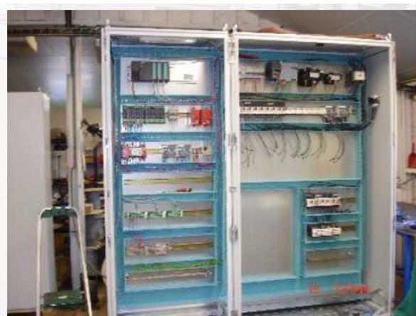
La suite du travail consiste ensuite en l'installation des **goulottes** pour le passage des fils, des **rails** pour la fixation des appareils et la mise en place de ces derniers.
