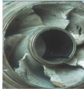
**Figure 2.4 : Effets du phénomène de cavitation sur des aubes de pompe centrifuge** (doc. Rhône-Poulenc)
