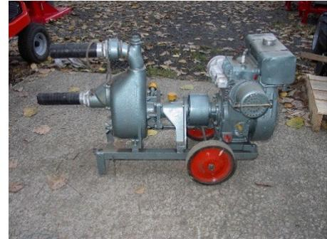
Le liquide est aspiré au centre du rotor par une ouverture appelée « distributeur ». Son rôle est de conduire le fluide depuis la conduite d'aspiration jusqu'à l'entrée du rotor. Une fois qu'elle est pleine de liquide, la pompe est alors amorcée. La vitesse du fluide qui entre dans la roue augmente ; par conséquent la pression diminue et engendre ainsi une aspiration et maintient l'amorçage.
