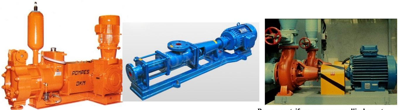
Pompe volumétrique à membrane (alternative) Pompe volumétrique à vis (rotative)
