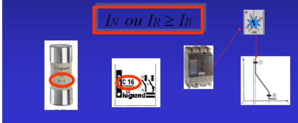
Les constructeurs donnent en général des tableaux (cf. §5 page suivante) qui permettent de déterminer directement les calibres des disjoncteurs terminaux en fonction de la puissance et de la nature du récepteur.
