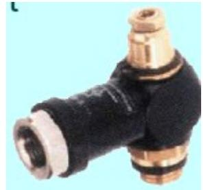
La restriction réglable est généralement réalisée par une vis pointeau verticale (ou plus rarement par une bague de réglage à rampe annulaire). L'anti-retour est assuré soit par une jupe en élastomère soit par une bille.
