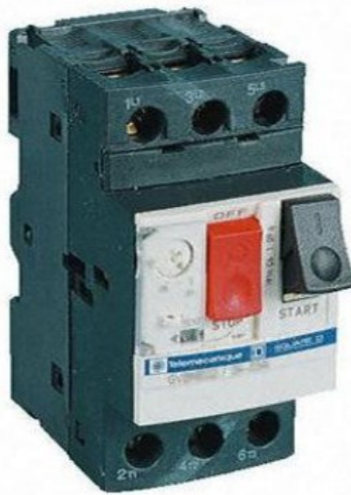
Disjoncteur-moteur magnétothermique (sectionneur+disjoncteur+relais thermique)
