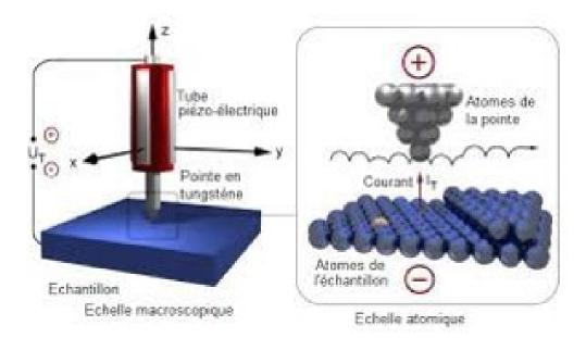
Suivant le sens de polarisation de la pointe les électrons peuvent
