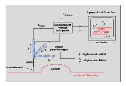
La pointe s'approche a la surface conductrice si le courant mesuré est plus faible que le courant de consigne.
