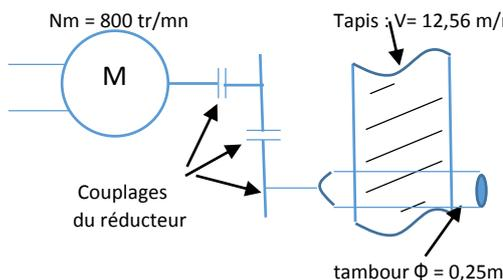
**Pm** : puissance mécanique **Pm** ou puissance utile **Pu** ou puissance nominale **Pn**: c'est la puissance disponible à l'extrémité de l'arbre du moteur.
