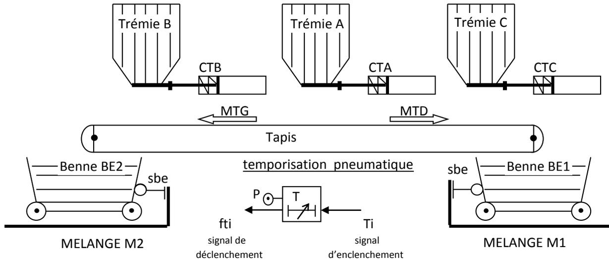
**Partie 1 : Technologie électropneumatique**
