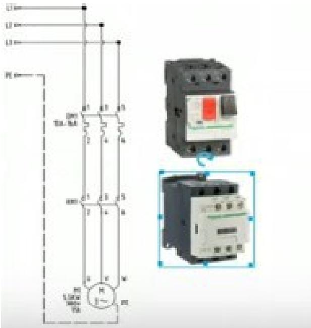
On remplace le sectionneur +les fusibles+le relais thermique par un dispositif unique : un disjoncteur-moteur, supportant un courant nominal de 43 A (pour le mélangeur) et 4,3A pour les pompes. On aura donc 4 disjoncteurs-moteurs alimentés par le sectionneur à fusibles Q1 calibré sur 50 A .
