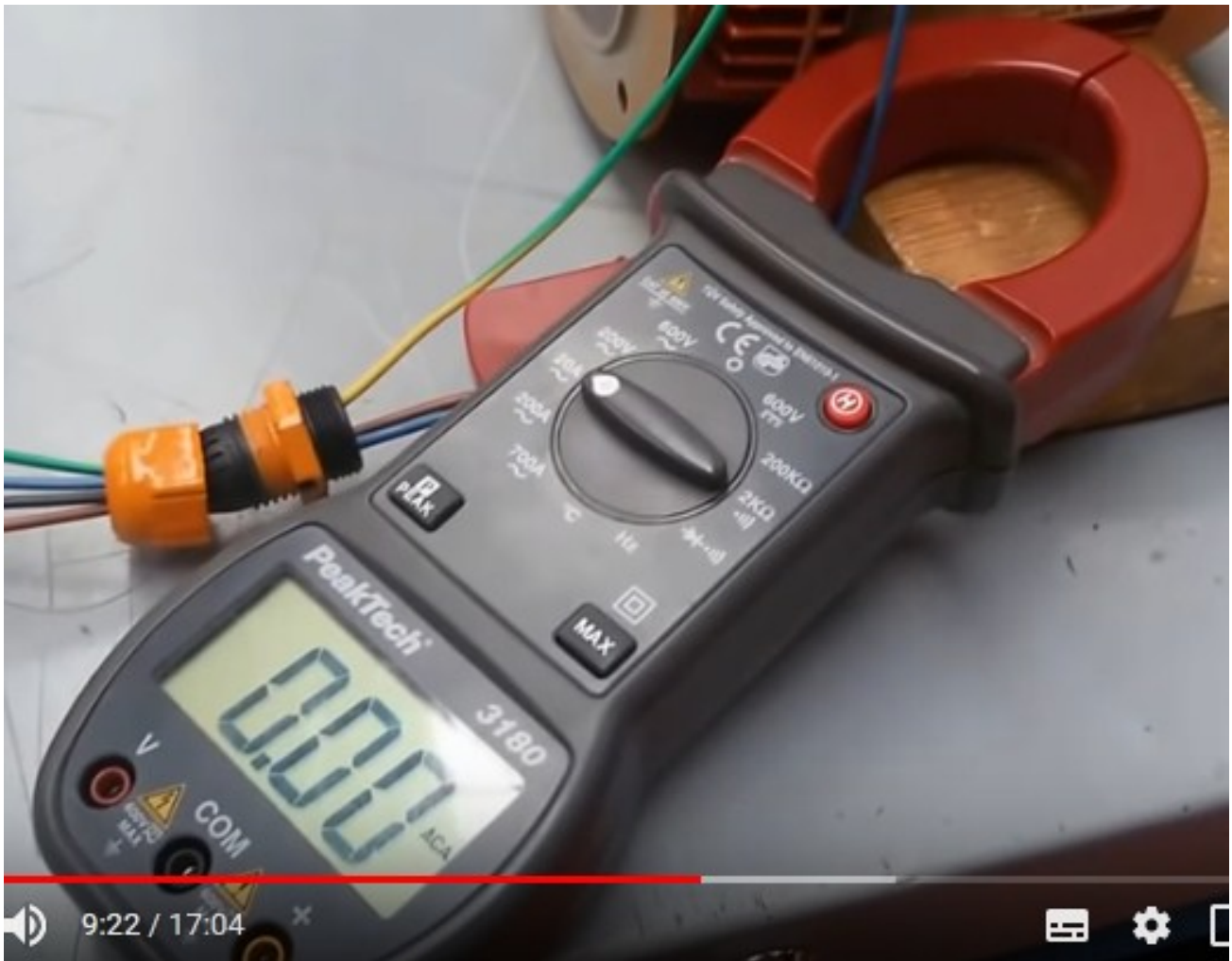
Pince ampèremétrique entourant le câble d'une des phases du moteur (à gauche le bouton PEAK)
